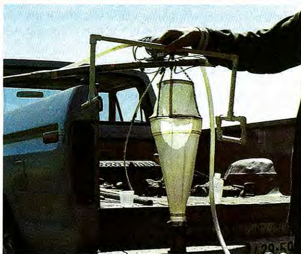
A Foto superior. Cladocerans como Bosmina longirostris são altamente sensíveis a substâncias tóxicas. Sua presença ou ausência fora da área afetada na zona de mortalidade é uma pista valiosa das possíveis causas da morte. Foto inferior. Rede de plânctons é usada para a coleta de zooplâncton para checar efeitos tóxicos.
