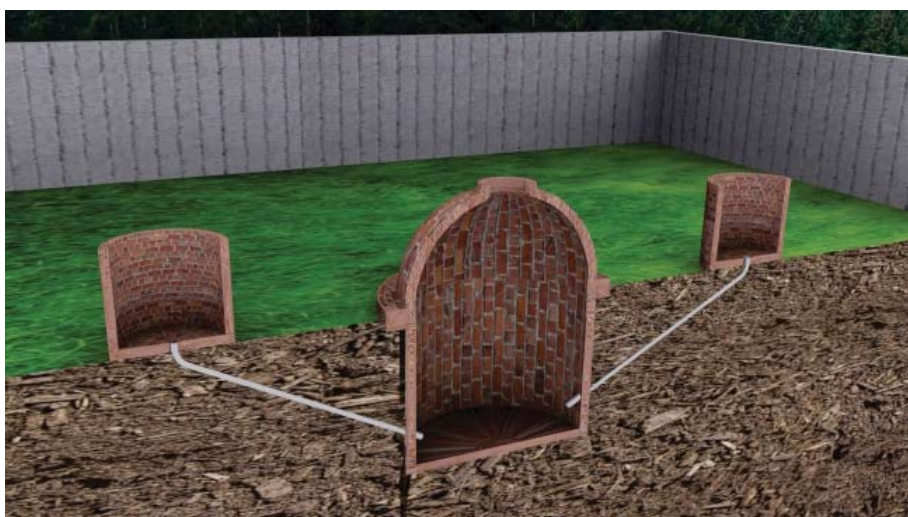
Figura 67 - Biodigestor do tipo chinês: (a) Representação tridimensional em corte; (b) vista lateral.
