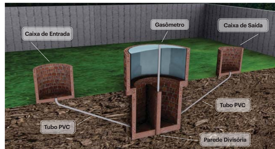
Figura 68 - Biodigestor do tipo indiano: (a) Representação tridimensional em corte; (b) vista lateral.
