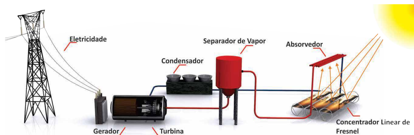
Figura 2.3.5 (b): Esquema de uma Usina Solar Termoelétrica
