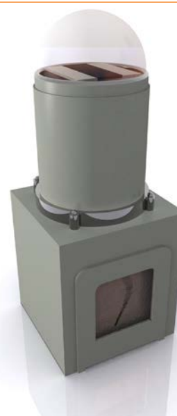
Figura 2.1.5: Actinógrafo bimetálico do tipo Robitzsch-Fuess
