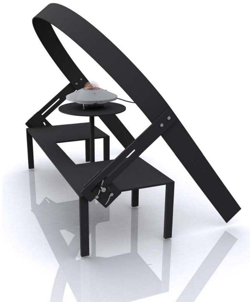
Fig. 2.1.10: Piranômetro com banda de sombra para medição de radiação difusa
