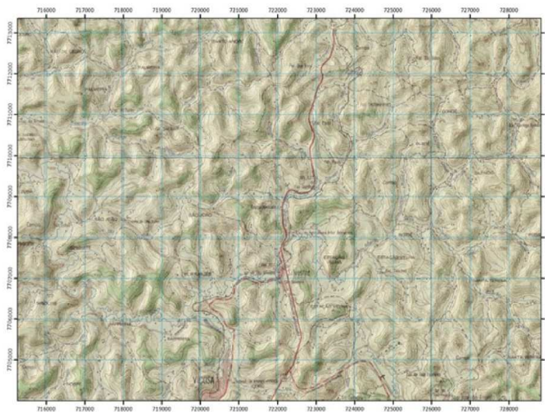
Figura 27 - Exemplo de Mapa de Combate. Sobreposição da carta topográfica sobre o mapa de sombras e relevo.
