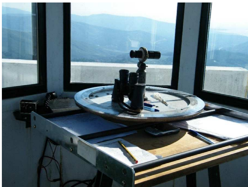
Figura 46 - Goniómetro num posto de vigilância fixa para incêndios florestais, em Vila Nova de Cerveira (Portugal).
