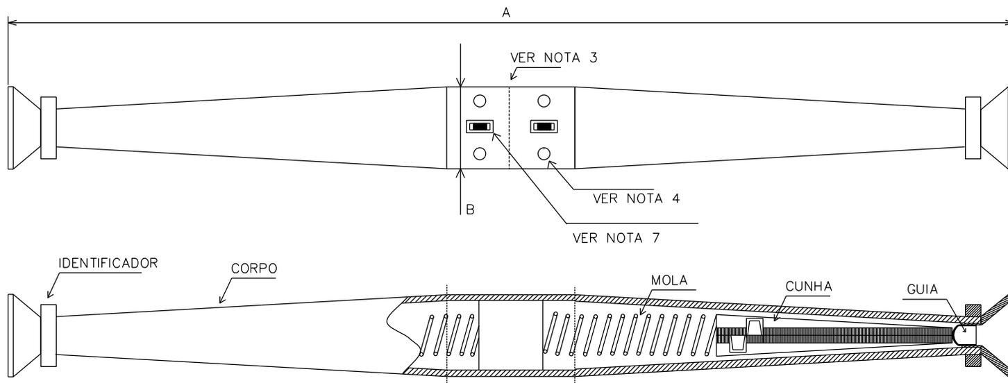
NOTA: PARA GARANTIR BAIXA RESISTÊNCIA ELÉTRICA DEVE SER APLICADA UMA TRAÇÃO MÍNIMA DE 5% DA CARGA DE RUPTURA DO CABO.
