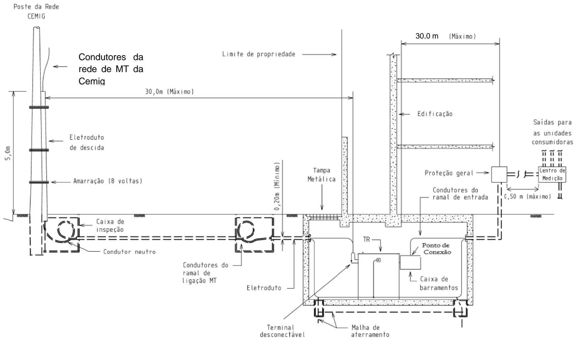
Desenho 4 - Definição Do Ponto De Conexão
