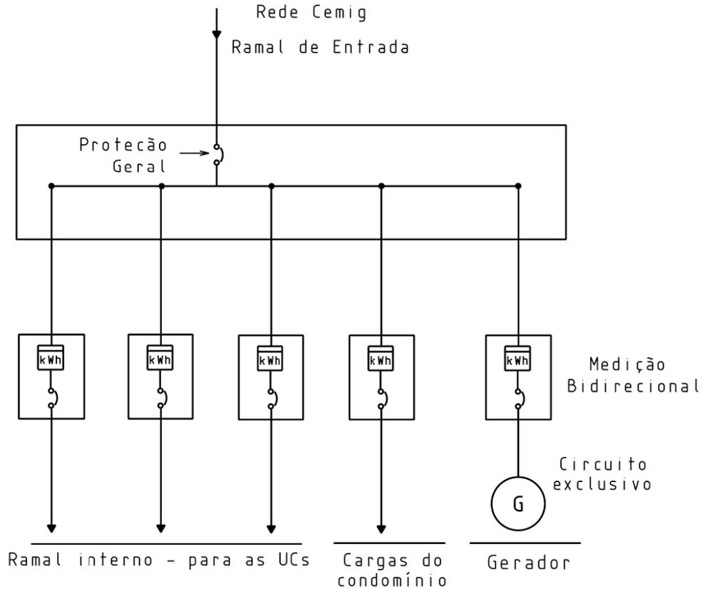
Figura 1 – Diagrama unifilar para a conexão de microgeração em EMUC
