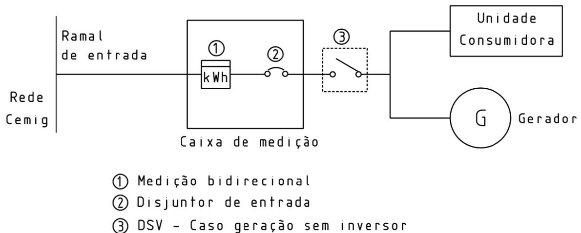
Figura 8 – Disposição simplificada do medidor bidirecional
