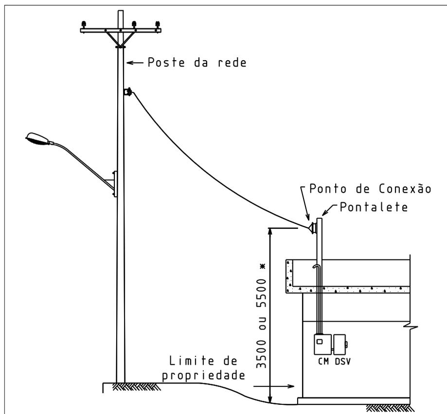
Figura 9 – Exemplo de disposição do padrão de entrada, DSV e caixa de medição com medidor bidirecional.
