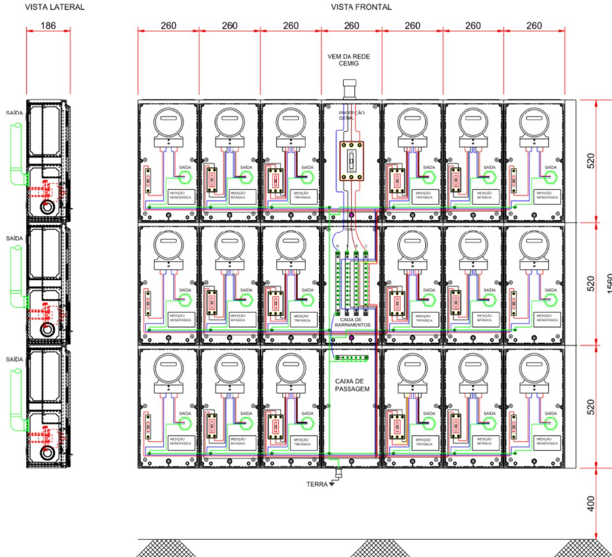
**DESENHO 20 - CENTRO DE MEDIÇÃO PRÉ-FABRICADO EM POLICARBONATO PARA DEMANDA ATÉ 86kVA – ALTERNATIVA DE MONTAGEM 2**
